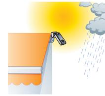
Cet automatisme est couplé à un capteur soleil. Il est alimenté par un câble électrique et est relié au moteur par radio.
