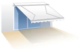
Le bras est constitué d'un avant-bras et d'un arrière-bras articulés par un axe de liaison, le coude, et actionnés par un système de tension à câble ou à ruban. **Simple et performant.**
