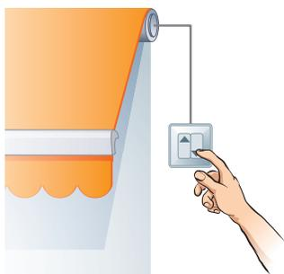
Point de commande mural relié par un câble électrique au moteur.
